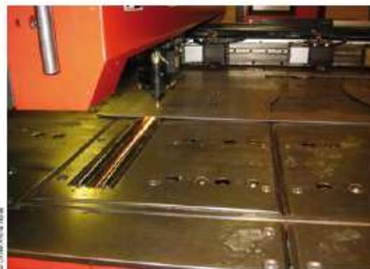
Fig. 18. Dispositif d'aspiration par fente fixe.
